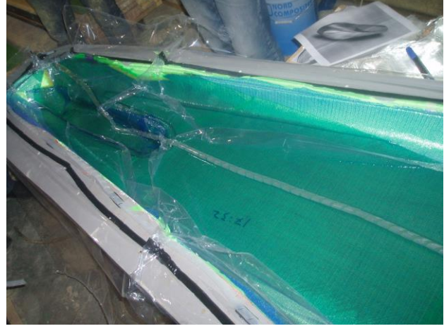
Şekil 3. İnfüzyon yöntemi ile alt gövdenin imalatı
