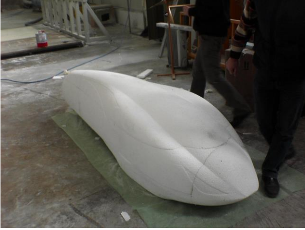
Şekil 2. Aracın CNC işleme tezgahından elde edilen modeli
